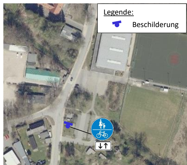
Abbildung 27: Radverkehrsführung Rudolf-Hartmann-Straße/Heinrich-Behrens-Weg (Karte auf Grundlage von Gaia-MV) Farbgebung dient nur zur Visualisierung
