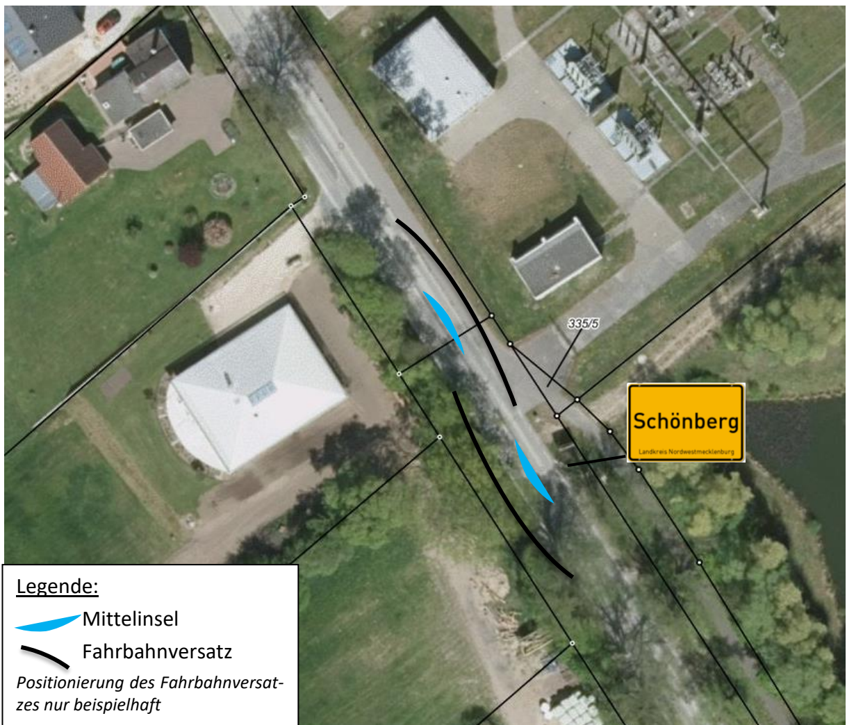
Abbildung 19: Mittelinsel im Bereich der Ortstafel Marienstraße (Karte auf Grundlage von Gaia-MV) Farbgebung dient nur zur Visualisierung
